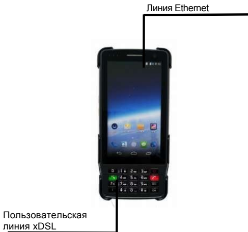
Схема подключения линий при эмуляции модема
